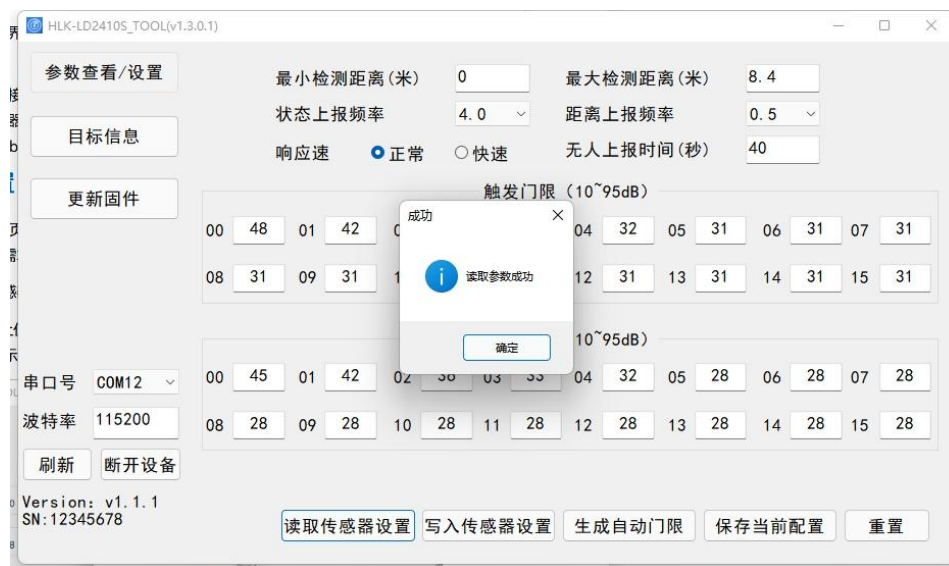
图 4-3 上位机读取传感器参数界面
